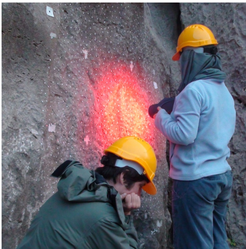
Fig. 6: Acquisizione con laser scanner del rilievo di Hung-e Yaralivand.
